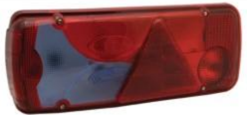
Dæmi um ljóساسamstæðu aftan á eftirvagni, glit leynist í öðrum flötum en þessum þríhyrnda.
